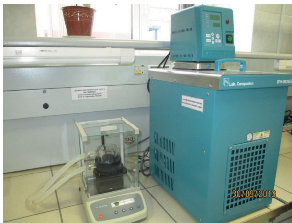
Рис. 2. Внешний вид тензиометра DST 60M в комплекте с криотермостатом RW-0525
