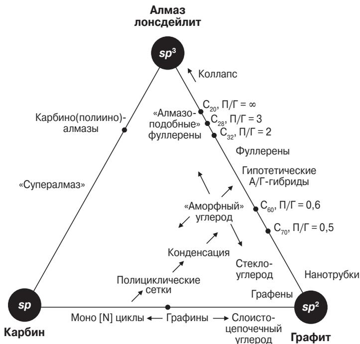
**Рис. 1.1.** Тройная диаграмма аллотропных форм углерода. П/Г – соотношение пента- и гексагонов; А/Г – алмазо-графитные гибриды (по [1])
