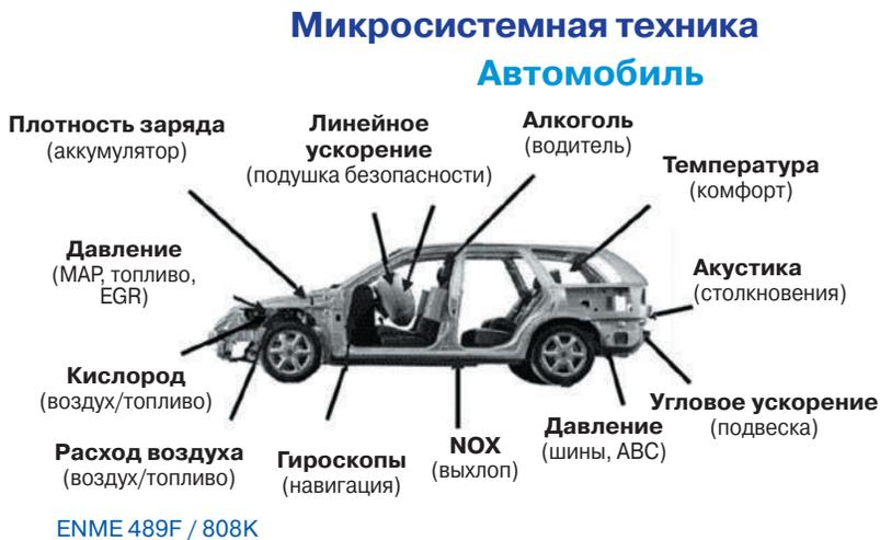
Рис. 1.16. МЭМС-устройства в автомобиле
