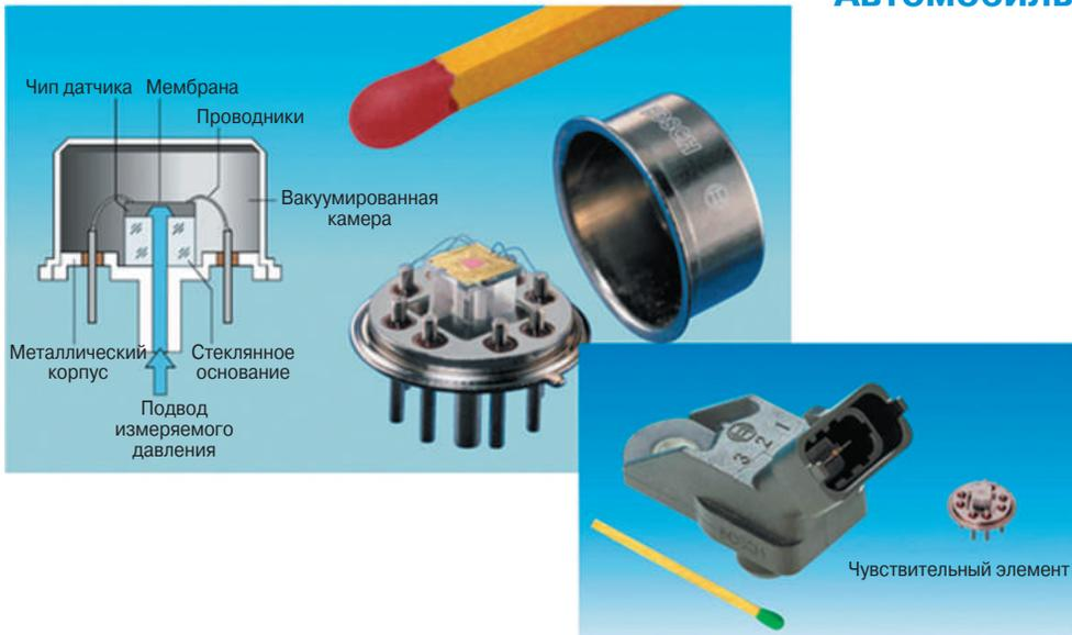
Рис. 1.17. Внешний вид и типовая конструкция автомобильного датчика давления
