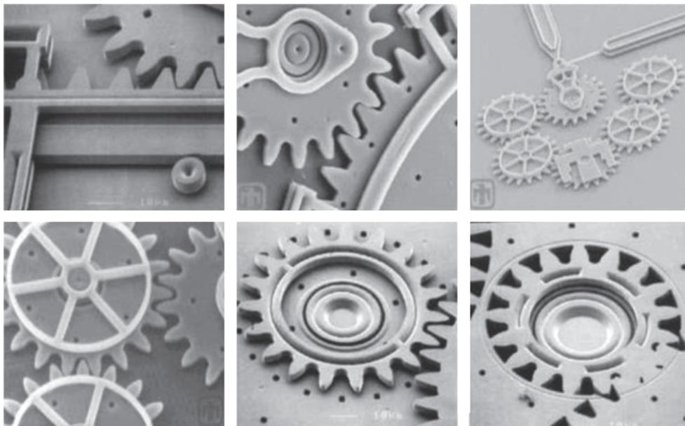
Рис. 1.11. Типовые конструкции зубчатых элементов гребенчатых микродвигателей МЭМС
