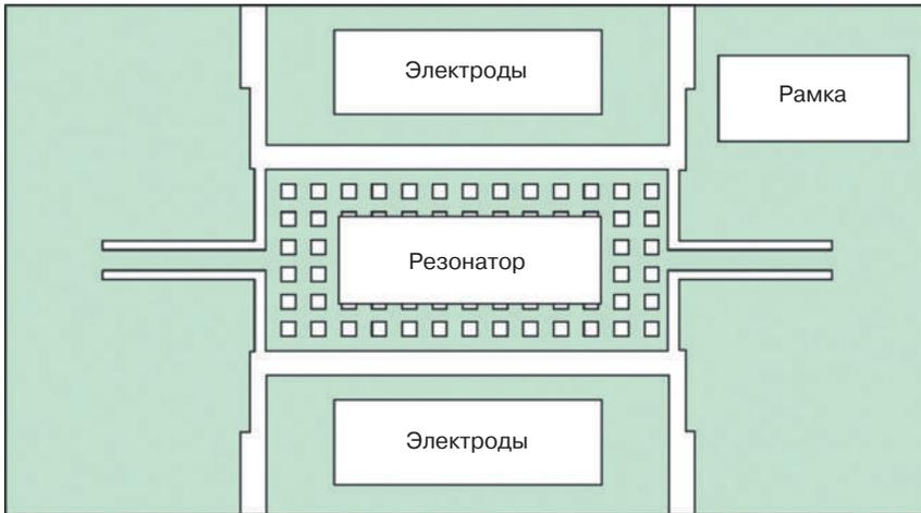
**Рис. 2.8.** Резонансная конструкция датчика: перфорированная масса, подвешенная на двух балках
