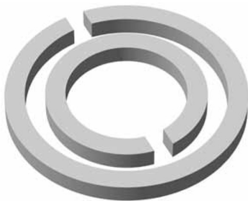
Рис. 16. Кольцевой разомкнутый резонатор (KPP, англ. Split ring resonator , SRR) (рис. 16). В этой структуре емкость между двумя кольцами компенсируется их индуктивностью. Изменяющееся во времени магнитное поле с вектором напряженности, перпендикулярным поверхности колец, вызывает потоки, которые в зависимости от резонансных свойств структуры порождают вторичное магнитное поле, усиливающее исходное либо противодействующее ему, что приводит к положительным или отрицательным эффективным значениям \mu . Магнитная проницаемость метаматериала, созданного с применением таких структур, описывается формулой
