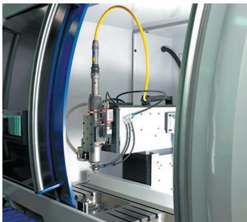
Рис. 1.3. ОЦ с интегрированным лазером
