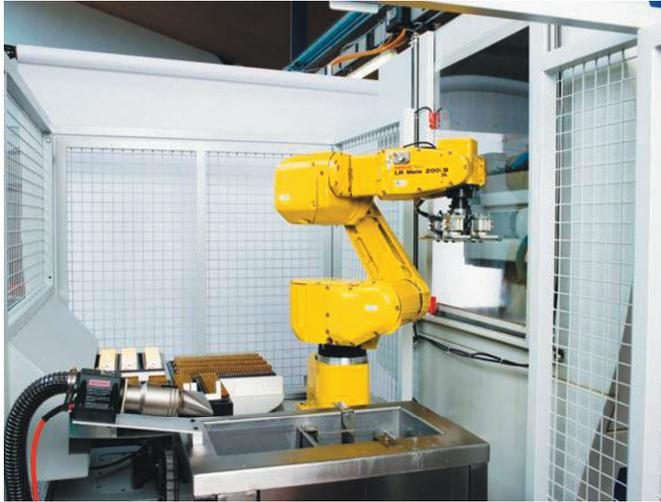
**Рис. 1.13.** Встроенный робот для перемещения заготовок пластин и обработанных микродеталей
