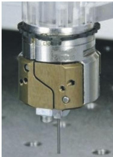
**Рис. 1.15.** Общий вид схвата, собранного из унифицированных узлов
