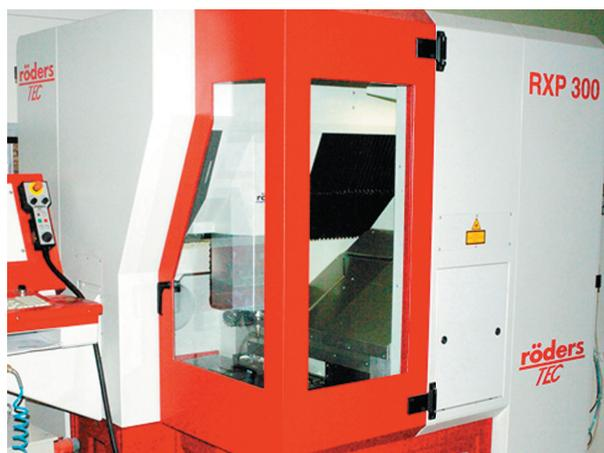
Рис. 1.4. Станок для микрообработки Roeders RXP 300
