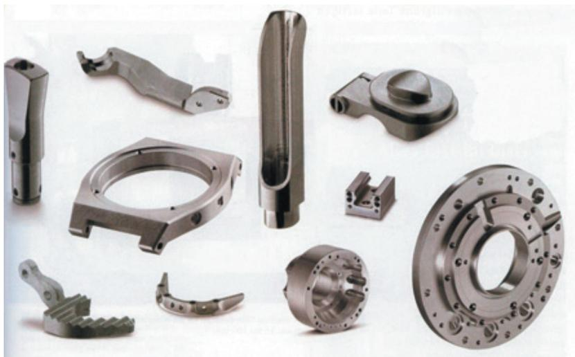
Рис. 1.1. Детали, изготавливаемые микрообработкой резанием
