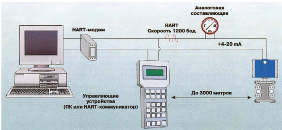
Рис. 1.18. Режим передачи цифровой информации одновременно с аналоговым сигналом
