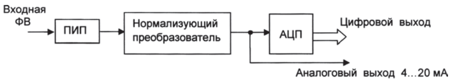
Рис. 1.5. Структурная схема согласования первичного измерительного преобразователя с АЦП
