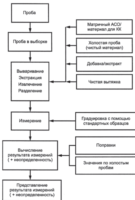
Рис. 2.8. Пример измерительной цепи для определения характеристик СО
