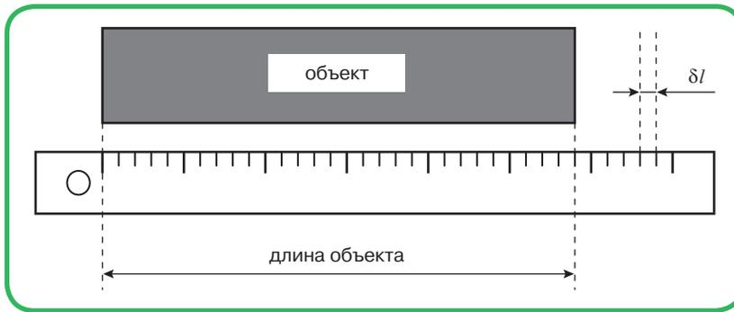
Рис. 2.3. Объяснение процесса измерения длины объекта
