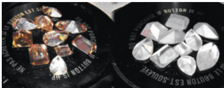
Рис. 2. Обесцвечивание алмазов путем термобарической обработки
