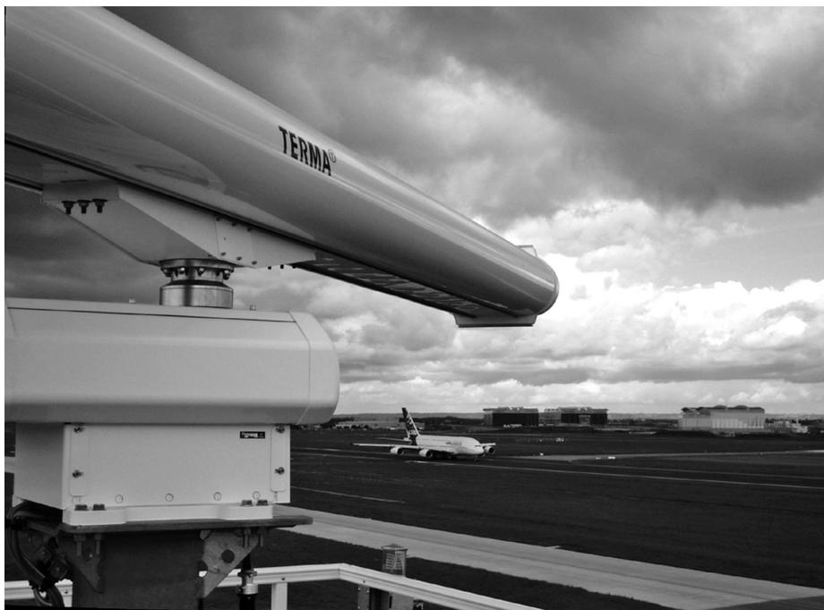
Рис. 1.36. Общий вид радара SMR Scanter
