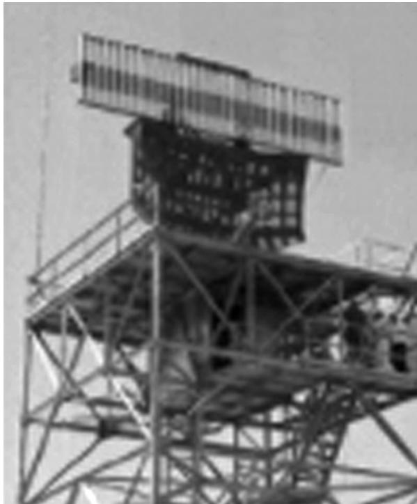
Рис. 1.35. Вид типового радара воздушного наблюдения ASR-12
