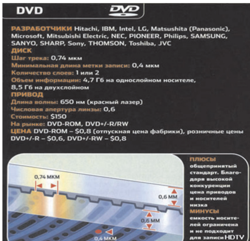
Рис. 1.1. Структура оптического диска типа DVD [50—51]
