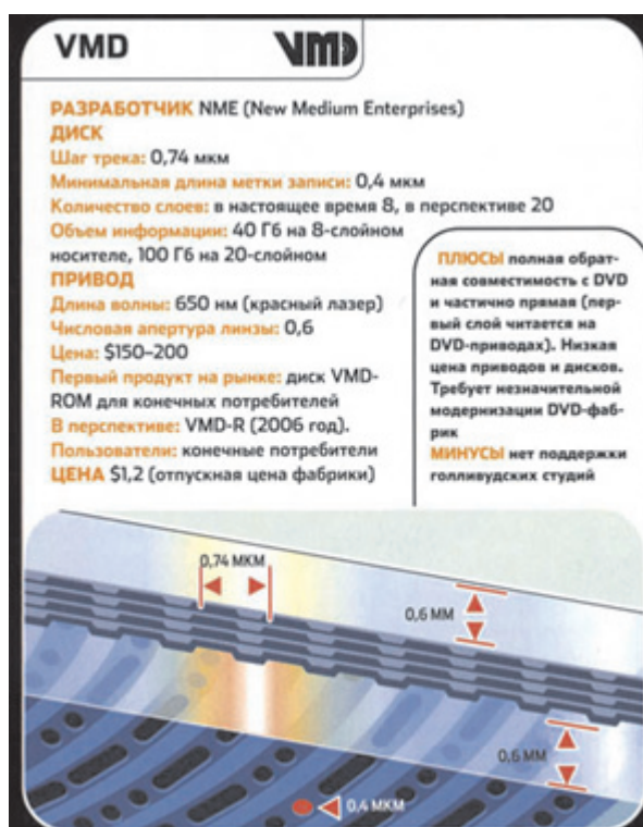
Рис. 1.4. Структура многослойного диска типа VMD [50—51]
