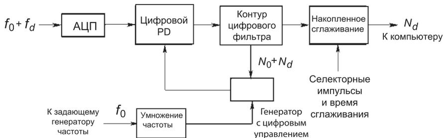
Рис. 2.18. Извлечение и измерение доплеровской частоты в PLL промежуточной частоты
