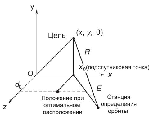
Рис. 2.9. Геометрическое расположение при определении орбиты одной станцией
