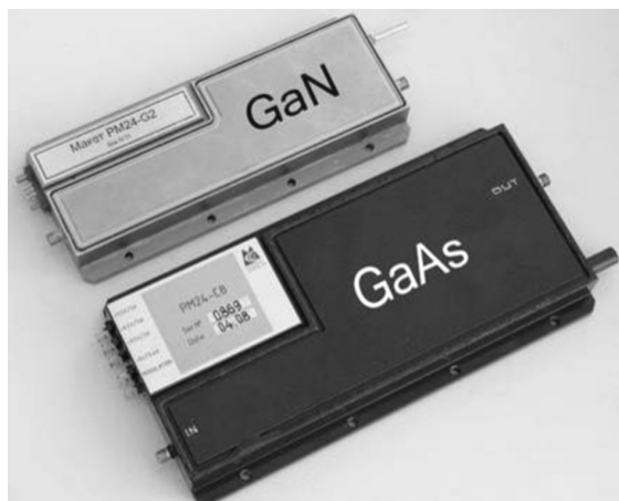
Рис. 10.21. Сравнение габаритов усилителей PM24-C8 (GaAs) и PM24-G2 (GaN)
