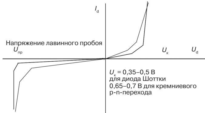
Рис. 2.5. Вольт-амперная характеристика диода Шоттки
