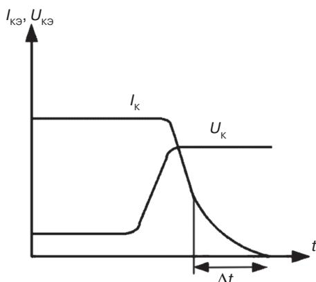
Рис. 2.14. Зависимость напряжения  $U_{K\bar{E}}$  и тока  $I_{K\bar{E}}$  при выключении IGBT
