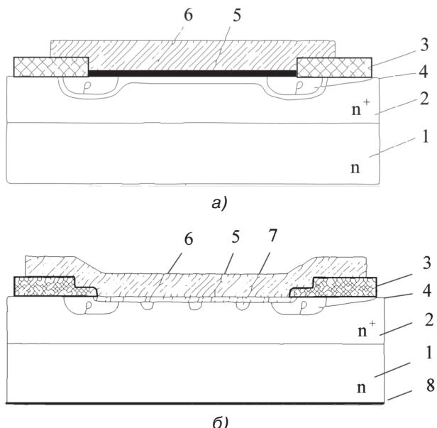
**Рис. 2.4.** Структура диода Шоттки: 1 — подложка; 2 — эпитаксиальный слой; 3 — слой  $\text{SiO}_2$ ; 4 — охранное кольцо; 5 — барьер Шоттки; 6 — металлизация анода; 7 — диффузионные области р-типа; 8 — металлизация катода
