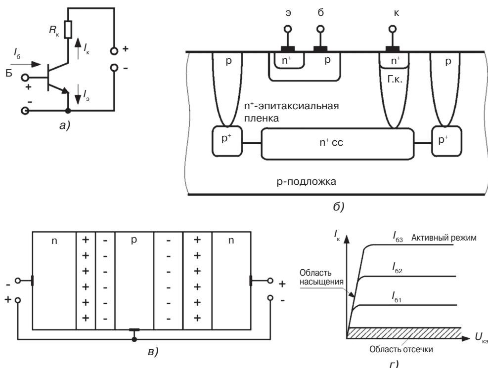
**Рис. 2.6.** Символьное обозначение со схемой включения с общим эмиттером (а), структура (б), упрощенная структура со схемой включения с общей базой (в) и выходная вольт-амперная характеристика n-p-n транзистора (г)
