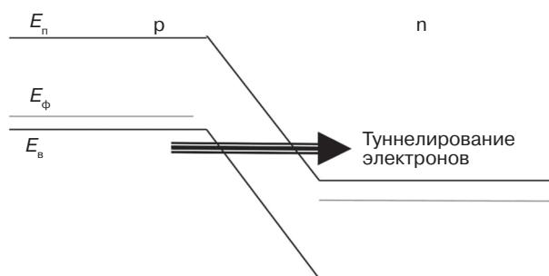
Рис. 2.3. Зонная диаграмма p-n-перехода с зенеровским (туннельным) пробоем
