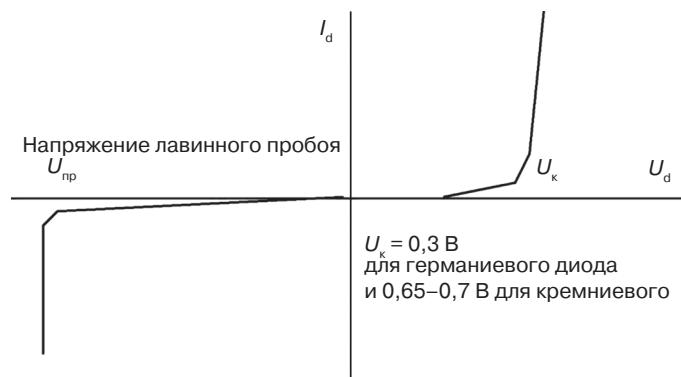
Рис. 2.2. Вольт-амперная характеристика диода
