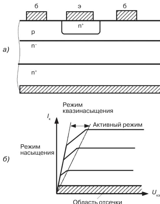
Рис. 2.7. Эскиз структуры (а) и выходная вольт-амперная характеристика (б) мощного n-p-n-транзистора
