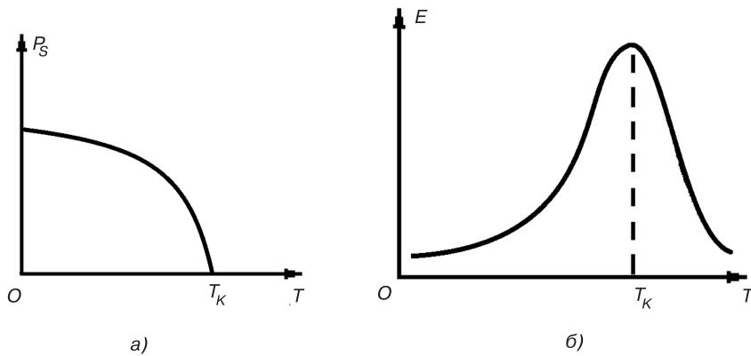
**Рис. 1.8.** Температурные зависимости: *а* — спонтанной поляризации; *б* — диэлектрической проницаемости
