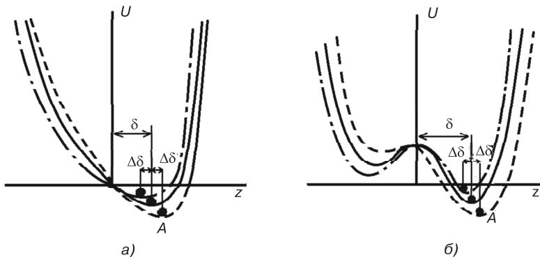
**Рис. 1.5.** Потенциальная энергия ионов в  $B$ -подрешетке от их смещения из центра элементарной ячейки: *а* — ион имеет одно положение равновесия; *б* — два
