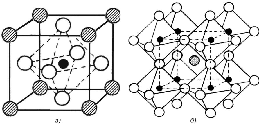
**Рис. 1.2.** Элементарная ячейка первовскитной структуры  $ABO_3$ : справа в вершинах куба (серые круги) — атомы  $A$ -подрешетки (Ba, Pb), в центре куба (черные круги) — атомы  $B$ -подрешетки (Ti, Zr), в центрах граней (светлые круги) — атомы кислорода
