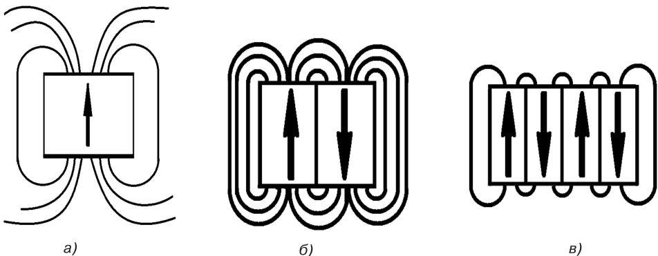
**Рис. 1.7.** Возникновение деполяризующего электрического поля и его последовательное уменьшение при разбиении кристалла на домены
