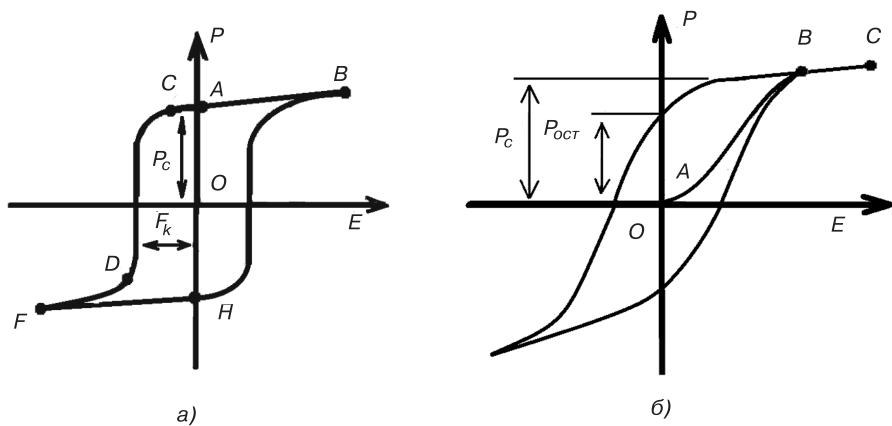
**Рис. 1.6.** Петли диэлектрического гистерезиса сегнетоэлектрика: *а* — одноосного сегнетоэлектрика; *б* — многоосного
