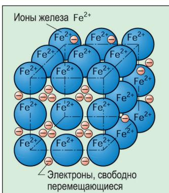
Рис. 2.20. Соединение металла (кристалл железа)
