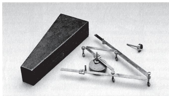
Рис. 2. Пентограф, принадлежавший Томасу Джейферсону
