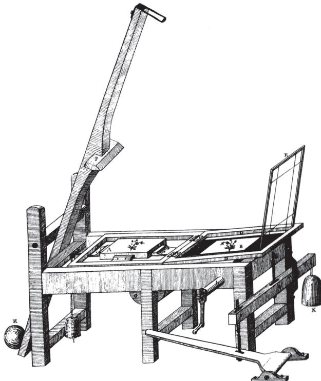
Рис. 1. Литографский печатный станок Зенефельдера
