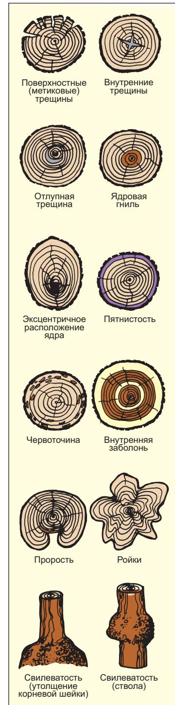
Рис. 2.19. Пороки древесины ствола (часть 2)
