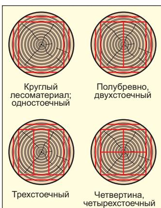
Рис. 2.37. Виды распиловки на брусья и балки
