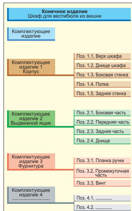
Рис. 1.13. Разбивка изделия на составные детали (пример)
