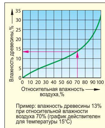
Рис. 2.81. Зависимость влажности древесины от относительной влажности воздуха
