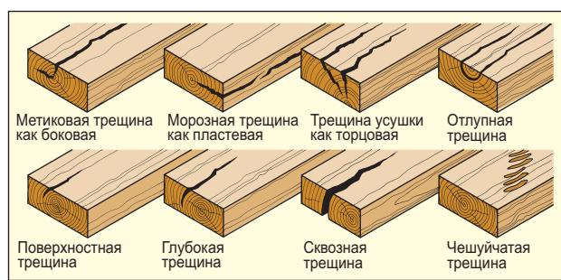
Рис. 2.44. Трещины
