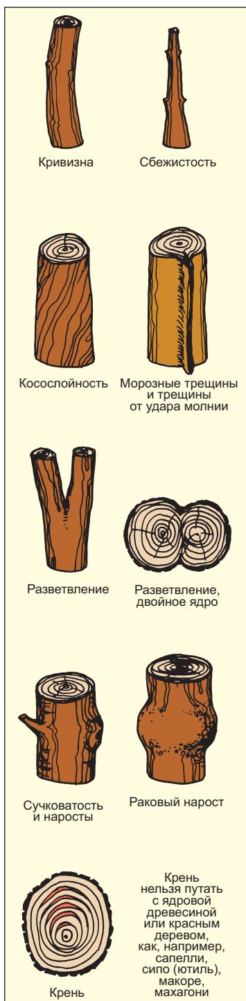
Рис. 2.19. Пороки древесины ствола (часть 1)
