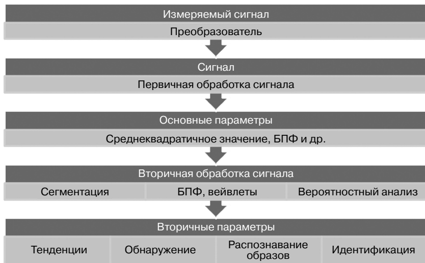
Рис. 1.5. Последовательность измерений, мониторинга и обработки сигналов
