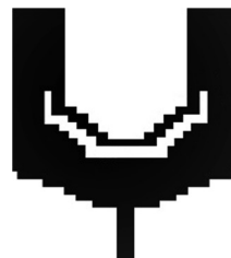
Рис. 11. Форма U-образного оптимизированного монополя
