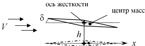
Рис. В.2. Профиль, совершающий изгибно-крутильные колебания в потоке
