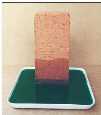
Рис. 2.38. Действие капиллярности в стеновом кирпиче после двухчасового всасывания воды
