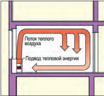
Рис. 2.81. Передача тепла за счет конвекции
