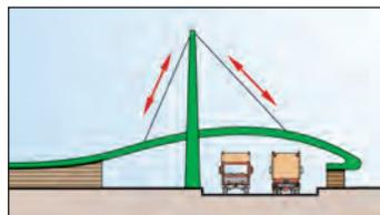
Рис. 2.62. Растягивающие напряжения в несущем канате (висячего моста)
