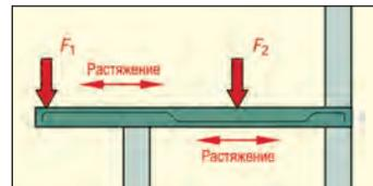
Рис. 2.65. Стальная арматура в перекрытии, выступающем в виде консоли
