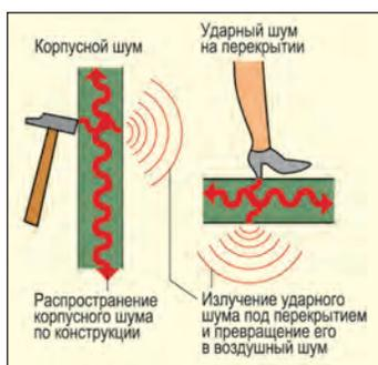
Рис. 2.85. Распространение корпусного шума
