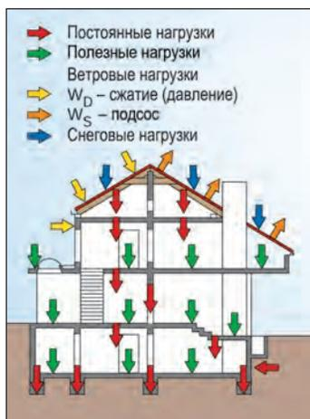
Рис. 2.59. Нагрузки на здание
