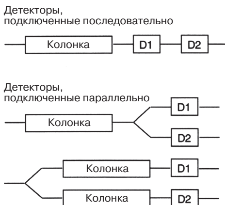
Рис. 2.13. Обычные конфигурации мультidetекторных систем
