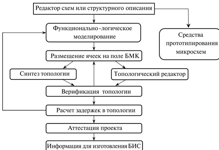
Рис. 2.3. Структурная схема САПР БИС «Ковчег 3.0»
