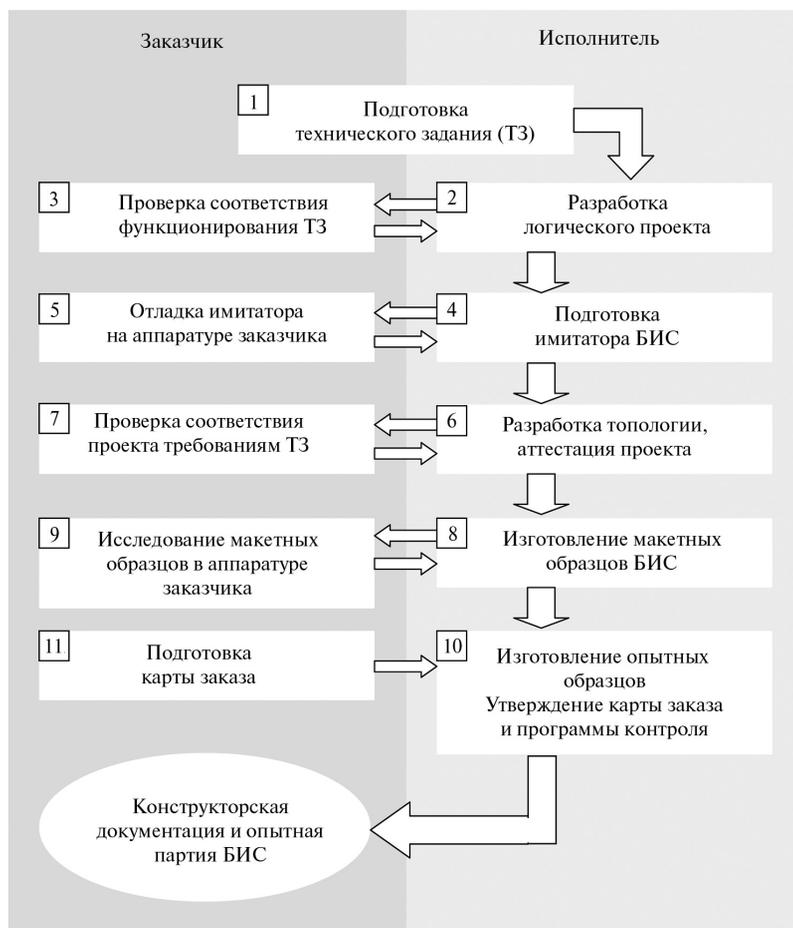
Рис. 2.5. Типовой маршрут взаимодействия с заказчиком при разработке полузаказной БИС
