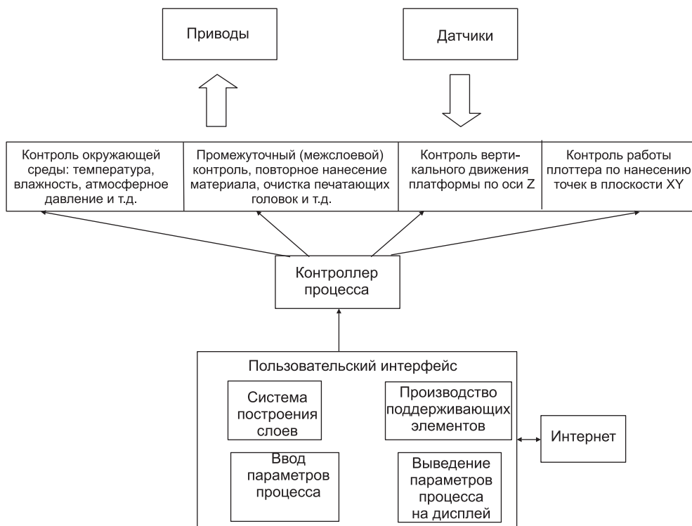
Рис. 2.1. Основные компоненты машины АП
