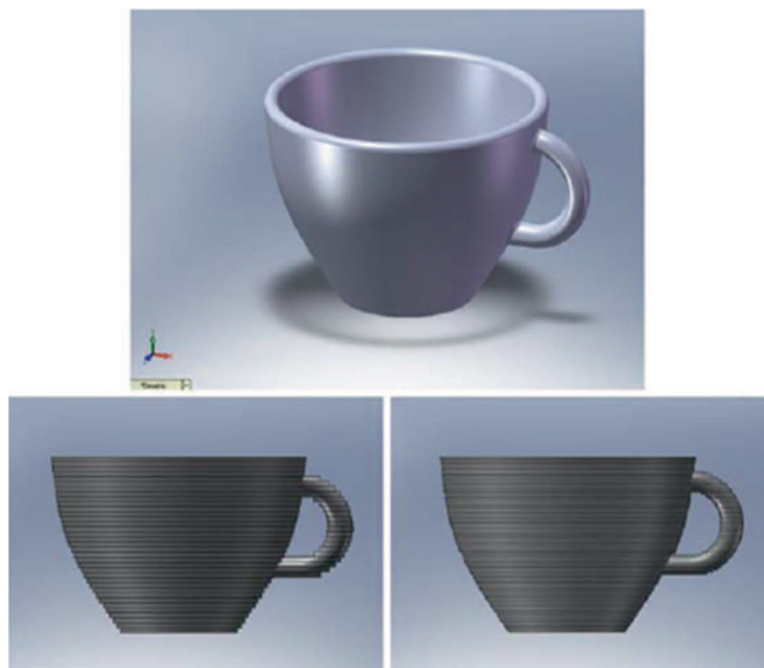
Рис. 1.1. Представление чайной чашки в САПР и изображения последующих моделей с использованием послойного синтеза изделия с разной толщиной слоев
