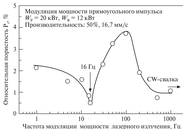
Рис. 2.21. Соотношение пористости P_p , формирующейся в процессе сварки, и частоты модуляции мощности лазера (модуляция мощности прямоугольного импульса)
