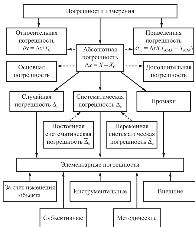
Рис. 1.3. Классификация погрешностей измерения
