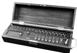
Арифмометр Карла Ксавье Томаса, 1820 г.
