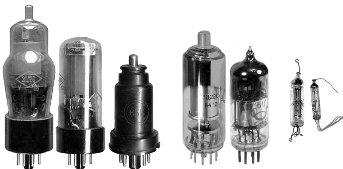
Рис. 3.7. Конструкции электронных ламп
