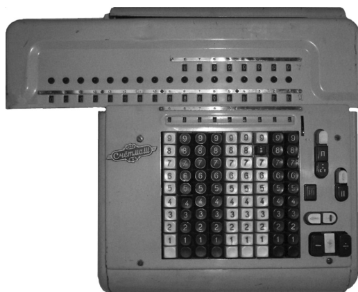
Рис. 3.16. Электромеханический арифмометр ВМП-1
