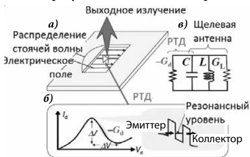
Рис. 1.18. Упрощенная конструкция генератора (а), ВАХ и соответствующая зонная диаграмма (б) и его эквивалентная электрическая схема с отрицательной проводимостью, параллельным контуром и проводимостью антенны (в)
