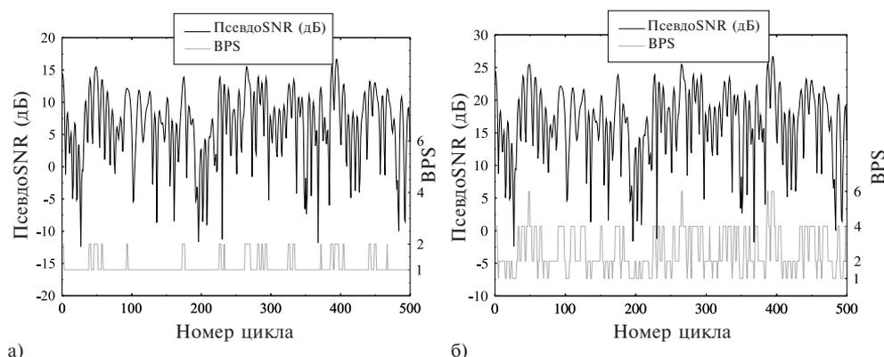
**Рис. 1.** Изменение режима модуляции в зависимости от уровня псевдоSNR, оцененного на выходе корректора канала в широкополосном модеме AQAM при передаче по типичному городскому каналу TU (Typical urban) с рэлеевскими замираниями. Число бит на символ (BPS — Bits per symbol) составляет 1, 2, 4 и 6 для BPSK, 4QAM, 16QAM и 64QAM соответственно. Отношение сигнал—шум SNR составляет 10 дБ (а) и 20 дБ (б)
