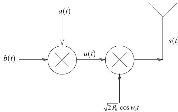
Рис. 1.3. Передатчик сигнала DS-SS с модуляцией ФМн (BPSK)
