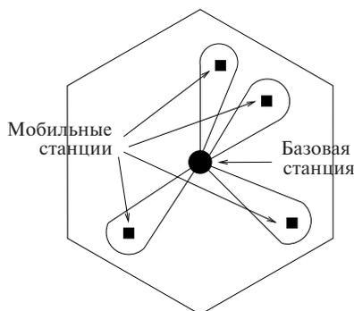
**Рис. 2.** Схема соты, иллюстрирующая, как антенная решетка позволяет поддерживать работу множества абонентов на одной несущей частоте или в одном временном интервале за счет пространственной фильтрации (SDMA)
