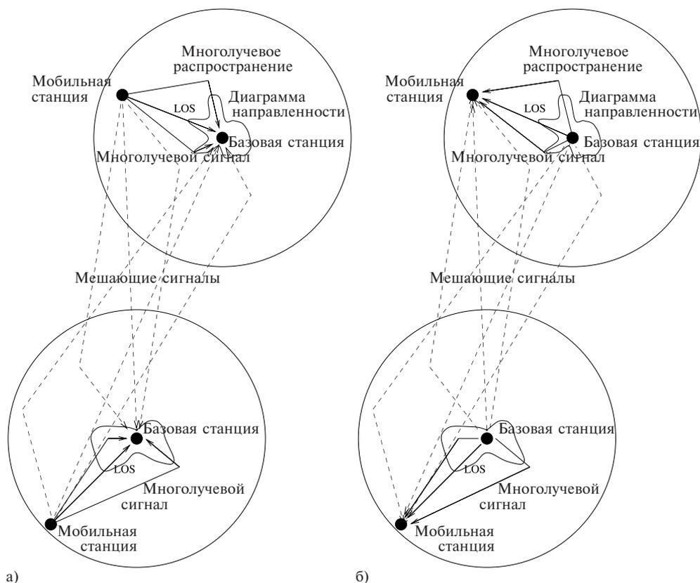
**Рис. 3.** Среда многолучевого распространения в направлениях UL (а) и DL (б) с указанием многолучевых составляющих полезных сигналов, помех в тракте прямой видимости (LOS) и соответствующих диаграмм направленности антенн на базовых станциях
