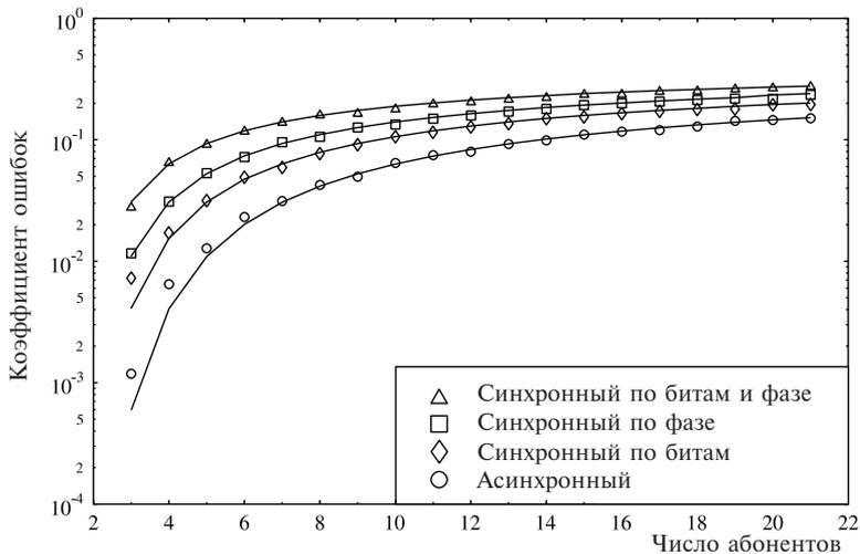
**Рис. 1.11.** Зависимости вероятности ошибки от числа абонентов, вычисленные по выражениям (1.28), (1.29), (1.30) и (1.31), а также на основе моделирования. Метки: моделирование; сплошные линии: вычисления. Выигрыш от обработки сигналов равен 7
