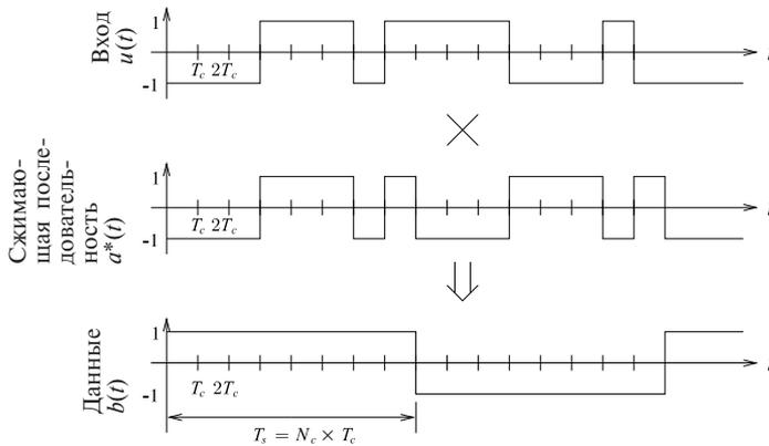
**Рис. 1.4.** Временная диаграмма декодирования сигнала, расширенного прямой последовательностью
