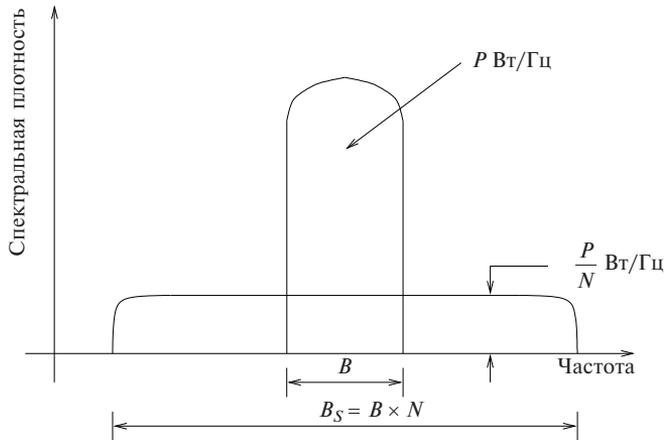
Рис. 1.1. Спектральная плотность сигнала до и после расширения
