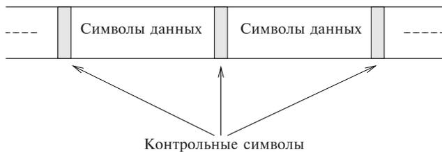
Рис. 1.14. Поток данных со вставленными контрольными символами
