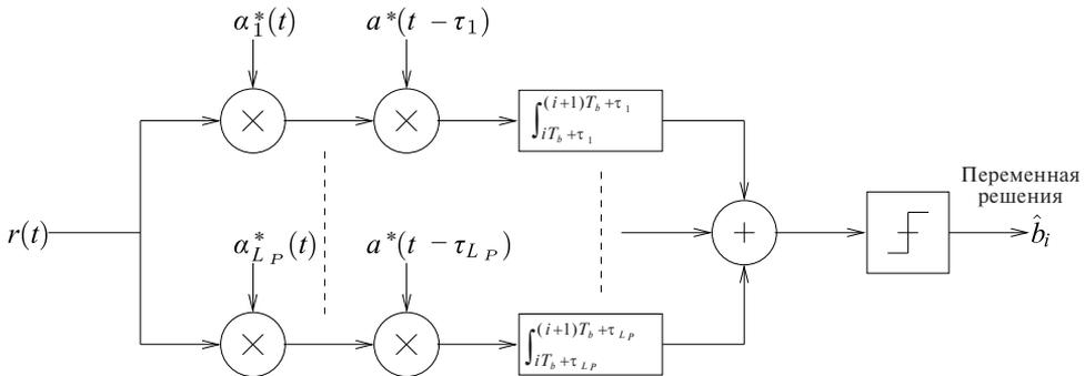
Рис. 1.9. Приемник Rake
