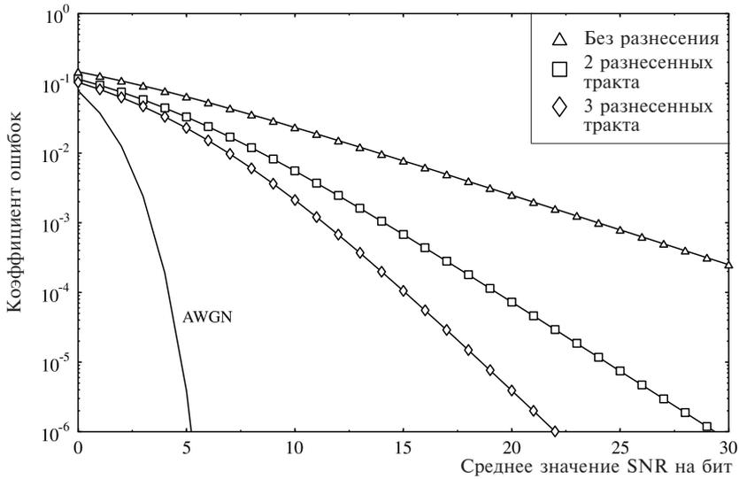
**Рис. 1.8.** Показатели системы CDMA с ФМн (BPSK) в различных каналах с рэлеевскими замираниями. Графики получены с использованием совершенного оценивания каналов и при отсутствии внутренней интерференции между разнесенными каналами
