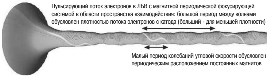
Рис. 1.22. Форма электронного пучка с «идеальной траекторией», проходящего от поверхности катода через магнитную периодическую фокусирующую систему в области пространства взаимодействия, для типичной ЛБВ Ку-диапазона. Параметры пушки Пирса: I = 150 мА, V = 7,5 кВ, диаметр канала 1 мм, заземленная трубка, B_{\text{пик}} = 0,325 Тл. (Моделирование проведено с помощью программы моделирования пушки в двумерном приближении, визуализация — с помощью условно-бесплатного программного обеспечения создания виртуальной реальности. Исполнитель В. Швертфегер, TED, Ulm. Использованы различные коэффициенты относительного масштабирования r = 8 \times z )
