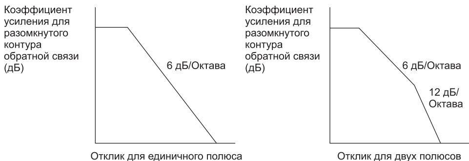
Рис. 1-27. Коэффициент усиления для разомкнутой схемы
